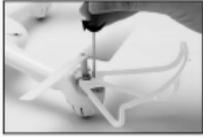
Закрепите защиту с помощью болтов (болты входят в комплект)
