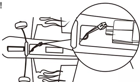
После полетов, аккумулятор необходимо извлечь из модели самолета и зарядить. Если не отключить аккумулятор от модели, он переразрядится и выйдет из строя! Аккумуляторы необходимо хранить в заряженном состоянии.
