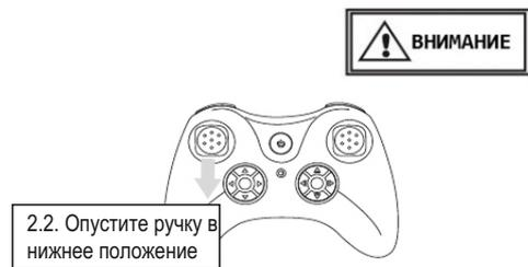
**ВАЖНО!** При падениях обязательно нужно сразу выключать обороты двигателя, для этого ручку газа необходимо перевести в нижнее положение. Если этого не делать, моторы быстро выйдут из строя, также могут выйти некоторые элементы платы от перегрузки!
