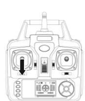
Важно! При падении обязательно нужно сразу выключить обороты двигателя, для этого ручку газа необходимо перевести в нижнее положение. Если этого не делать моторы быстро выйдут из строя, так же могут выйти из строя некоторые элементы платы от перегрузки.
