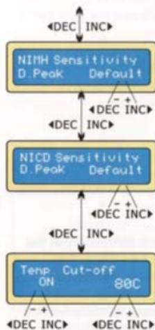
Этот параметр устанавливает значение “дельта-пик” при котором прекращается заряд NiCd и NiMH аккумуляторов. Рабочее значение 5-20мВ на ячейку. Если значение выше необходимого, то есть опасность перегрева аккумулятора. Если значение меньше необходимого, то возможно преждевременное отключение заряда. Следуйте указаниям инструкции к аккумулятору. (Заводские установки: NiCd: 12мВ, NiMH: 7мВ)
