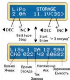
На этом дисплее пользователь устанавливает ток и напряжения для хранения аккумулятора. Функция заряда или разряда доведет напряжение аккумулятора до установленного "STORAGE" уровня.
