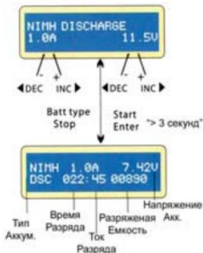
В левой части устанавливается ток разряда, в правой устанавливается напряжение до которого необходимо разрядить аккумулятор. Ток разряда регулируется в пределах 0.1-1.0A Напряжение разряда регулируется в пределах 0.1-25.0В
