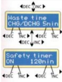
В процессе цикла заряда/разряда аккумулятор нагревается. Этот параметр устанавливает задержку по времени между каждым процессом заряда/разряда для того, чтобы аккумулятор успел остыть перед очередным циклом
