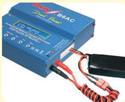
Основной кабель заряда должен быть обязательно подключен вместе с балансировочным кабелем перед зарядом аккумулятора.
