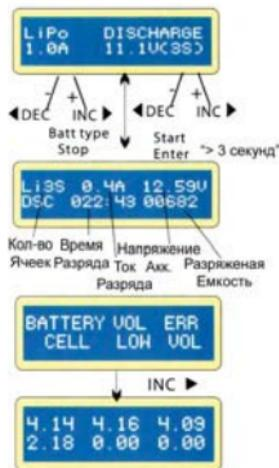
Ток разряда в левой части дисплея не может превышать 1С. Напряжение в правой части не может быть ниже указанного производителем аккумулятора, для избежания переразряда. Удерживайте кнопку START/ENTER более 3 секунд для начала разряда.
