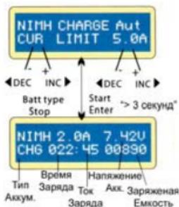
Эта программа используется для заряда NiCd/NiMH аккумуляторов применяемых в радиоуправляемых моделях. Для изменения значений необходимо нажать кнопку START/ENTER после чего значение параметра начнет мигать и его можно изменить кнопками "INC" и "DEC". Для сохранения необходимо нажать кнопку START/ENTER еще раз.
