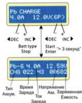
В левой части устанавливается ток заряда, в правой устанавливается номинальное напряжение аккумулятора. Ток заряда регулируется в пределах 0.1-5.0A. Напряжение должно соответствовать спецификации аккумулятора.
