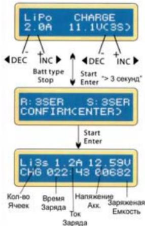
Левая часть верхней строки отображает тип аккумулятора. Значение во второй строке слева ток заряда. После установки тока и напряжения, для начала заряда удерживайте кнопку START/ENTER более 3 секунд.
