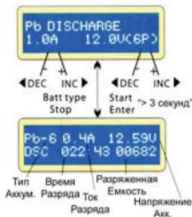
В левой части устанавливается ток разряда, в правой устанавливается номинальное напряжение аккумулятора. Ток разряда регулируется в пределах 0.1-1.0A. Напряжение должно соответствовать спецификации аккумулятора.
