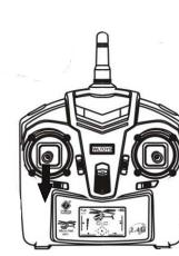
**ВАЖНО!** При падениях обязательно нужно сразу выключать обороты двигателя, для этого ручку газа необходимо перевести в нижнее положение. Если этого не делать, моторы быстро выйдут из строя, также могут выйти некоторые элементы платы от перегрузки!
