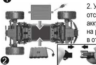
2. Установка аккумулятора в модель. Откройте отсек в нижней части модели, соедините разъем аккумулятора с разъемом модели, как показано на рисунке 2. Затем разместите аккумулятор в отсеке машины и закройте крышку отсека.
