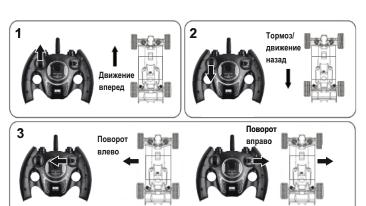
Для управления автомобилем используется пульт управления. Для удобного использования возьмите пульт в две руки. Для движения вперед необходимо нажать на кнопку вперед, как показано на рис. 1. Чтобы затормозить, однократно нажмите на кнопку движение назад рис. 2.
