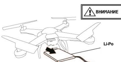
Важно! После полётов всегда отключайте Li-Po аккумулятор от модели, если оставить аккумулятор подключённым к модели он может переразрядится и выйти из строя! Хранить аккумуляторы в разряженном состоянии так же губительно для них! Так же после зарядки отключайте аккумулятор от зарядного!
