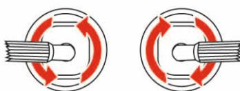
Для калибровки гироскопа необходимо включить пульт и нажать на кнопку калибровки пульта, как показано на рисунке на 3 секунды и пульт издаст 3 сигнала, при этом индикатор на пульте начнет медленно. Затем необходимо переместить ручки полностью по кругу 2 раза, затем еще раз нажмите кнопку калибровки пульта на 3 секунды. Пульт издаст 3 длинных звуковых сигнала и индикатор начнет моргать быстро.
