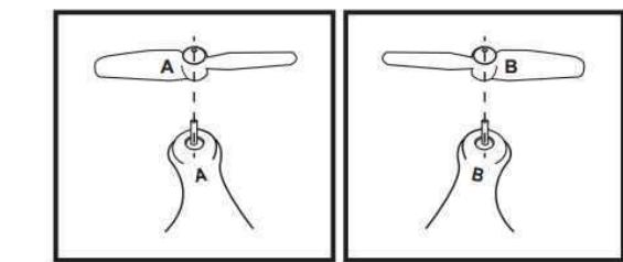
Лопасти в квадрокоптере имеют разное направление для вращения. При замене лопастей, нужно устанавливать лопасть «A» на луч «A», а лопасть «B» на луч «B»
