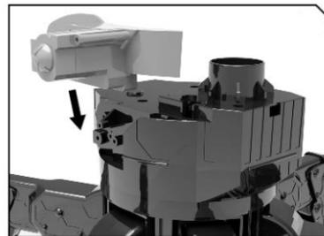
Для установки ракет в барабан, извлеките его из посадочного гнезда (оттяните назад и выдвиньте вверх, как это показано на рисунке). Установите ракеты, соблюдая направление, после чего установите барабан на место.
