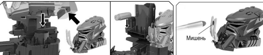
После установки боевой башни с оружием, аккуратно установите главную башню робота и Инфракрасный датчик. Основная башня имеет три индикатора жизни и сигнализирует о попадании в робота.
