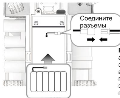
**ВНИМАНИЕ!** Всегда отключайте аккумулятор от модели после эксплуатации, отключайте аккумулятор от зарядного устройства по окончании процесса заряда, если этого не делать - аккумулятор переразрядится и выйдет из строя!
