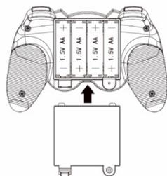
Аккумуляторный отсек находится в нижней части модели
